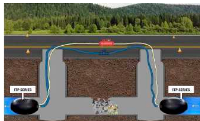
Рисунок-4 Серия ITP в применении при повреждении трубопровода
