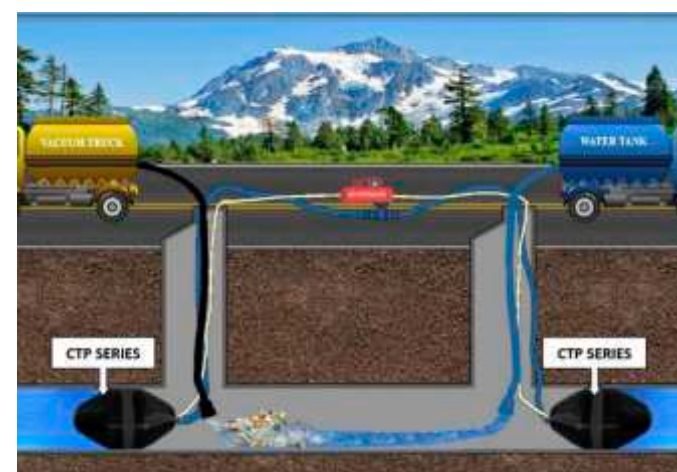
Рисунок-6 Серия CTP в трубопроводе для обхода воды для очистки
